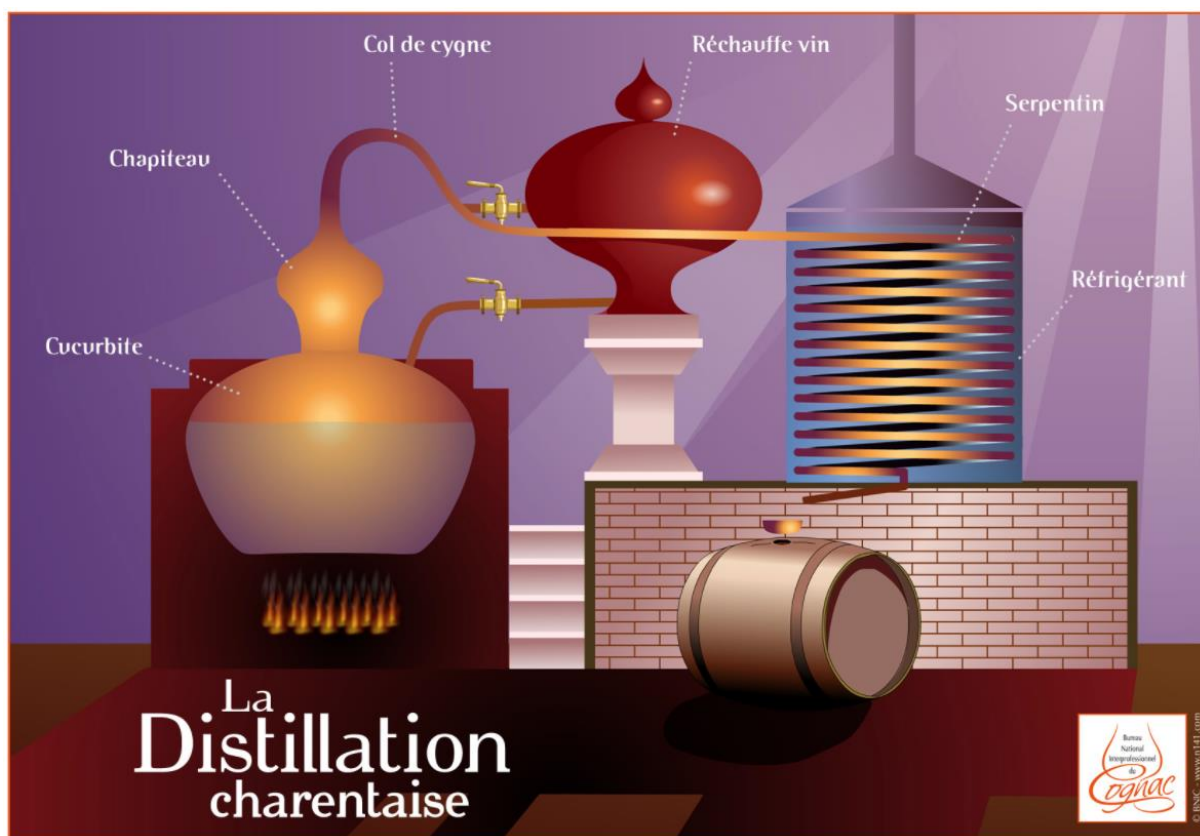
Figure 7 : Constitution d'un alambic charentais
